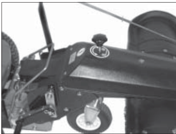
3) Optimaler Bürstendruck: Senken Sie die Bürste so- weit ab, daß sie gerade eben den Boden berührt. Dann noch 3 Umdrehungen entgegen dem Uhrzei- gersinn in Pfeilrichtung (-) drehen.
