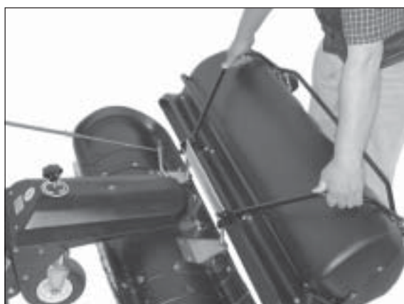
3) Kehrgutbehälter auf die Aufnahmestangen stecken und nach unten schieben.
